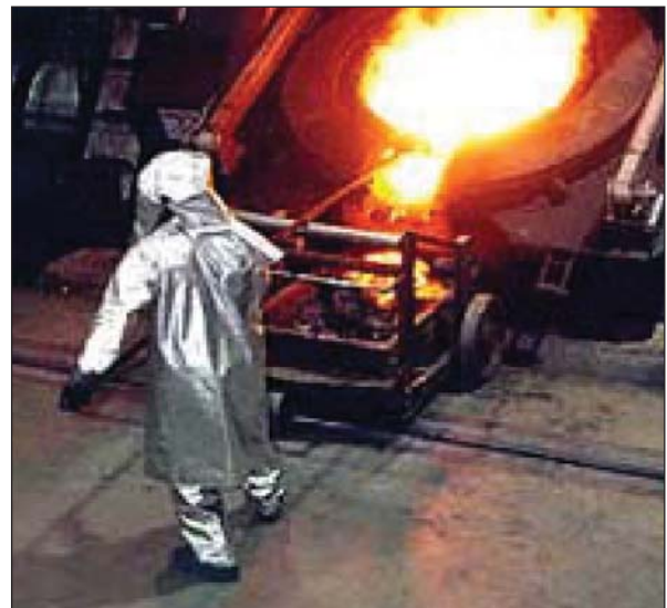
Fig. 12: Back slag removal.
